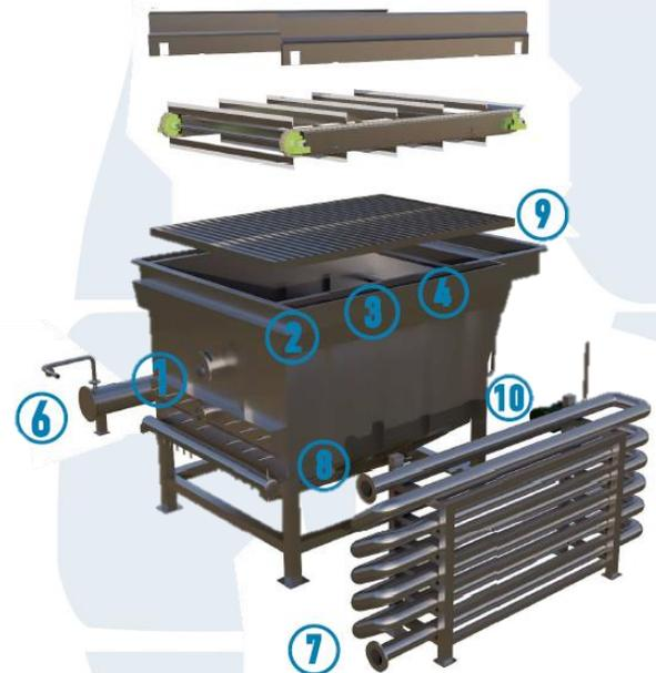
FIG. 1. ESQUEMA DE FUNCIONES DEL EQUIPO CLARIFICADOR TIPO DAF
